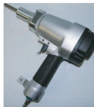
Imagen 33.- Equipo de perno cautivo penetrante.
