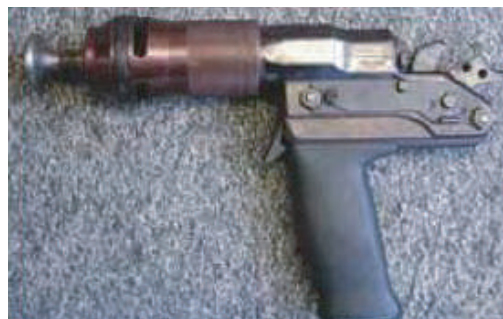
Imagen 34.- Equipo de perno cautivo no penetrante.
