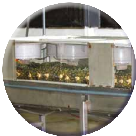
Secado / Escurrir exceso de humedad.
