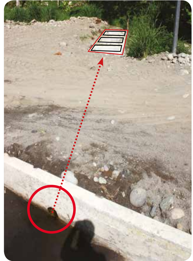
Zona de lavado de tanques de plaguicidas y / o combustibles, indicando canal de recolección y fosa de tratamiento de residuos tóxicos.
