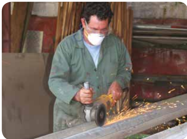
Personal de taller usando equipo de protección personal.
