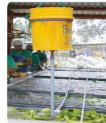
Equipo aplicador de removedor de látex por goteros en la tina.
