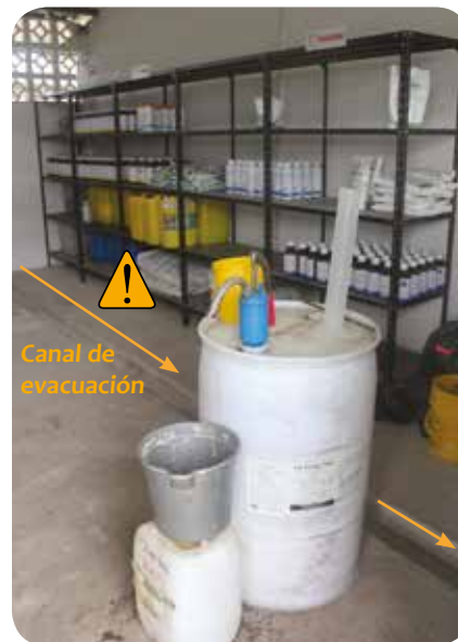
Bodega de agroquímicos, ver perchas de material no absorbente y colocación de plaguicidas.
