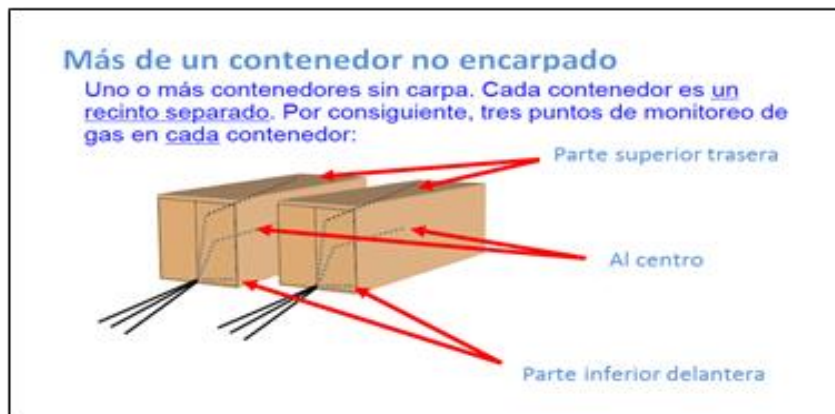
Figura 23 Disposición de mangueras de monitoreo en contenedores. Nota: Manual de Fumigación con bromuro de metilo según Norma de la DAFF
