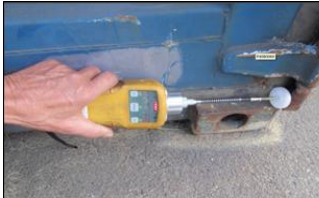
Figura 15 Revisión de fugas con dispositivo electrónico de altas concentraciones
