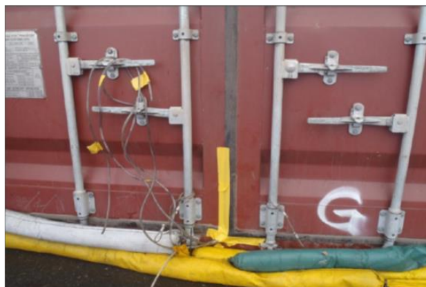
Figura 7 Colocación de culebras de arena en la parte inferior y al contorno de un contenedor para evitar fugas de fumigante durante la fumigación.
