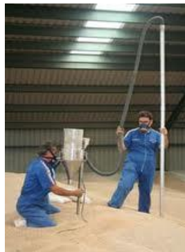
Figura 8 Gráfico donde se muestra la introducción de fumigante en carga a granel, Nota:
