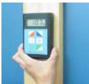
Se coloca el detector de humedad de madera sobre la madera. La radiación penetra en la madera hasta una profundidad de 25 mm y determina la humedad absoluta. Las curvas características de las densidades brutas de maderas están almacenadas en el aparato y se pueden elegir de un modo muy sencillo. De esta manera se garantiza que la humedad se determine específicamente para un tipo de madera determinado con una gran precisión
