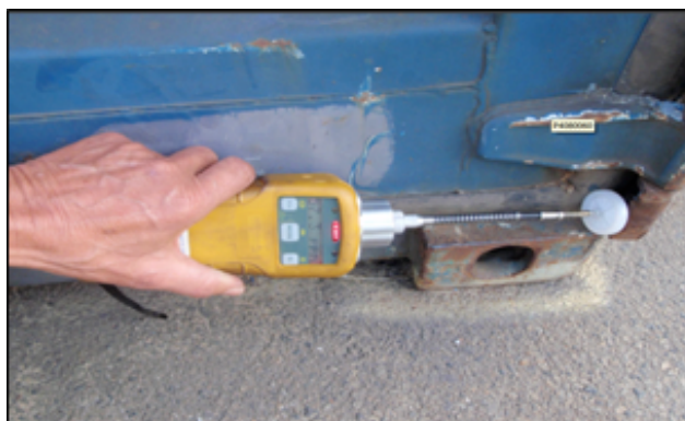
Imagen donde se observa la revisión de fugas en contenedor no encarpado con dispositivo electrónico de altas concentraciones alrededor de los sellos en las puertas
