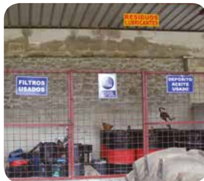
Clasificación de desechos lubricantes dentro de taller de mantenimiento para envío a gestores calificados.
