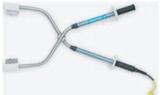
Imagen 31.- Equipo para aturdimiento eléctrico.
