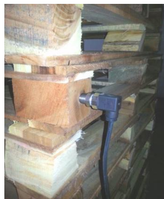
Figura 12. Ubicación de las termocuplas en embalajes de madera para registro y control de temperatura
