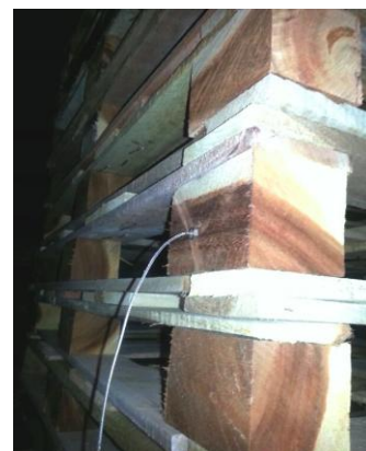
Figura 12. Ubicación de las termocuplas en embalajes de madera para registro y control de temperatura
