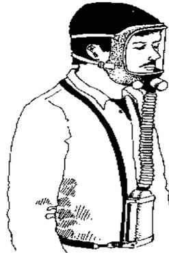
Figura 1 Tipos de mascarillas fullface que se utilizan como equipo de protección personal para evitar efectos nocivos en las vías respiratorias de los operadores
