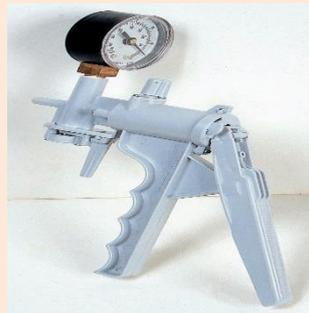
*Antes de la introducción del fumigante, conecte la bomba de mano a la línea de monitoreo. Apriete el mango. Si la línea está bloqueada, el manómetro de vacío de la unidad indicará un vacío. Para el monitoreo de líneas de 7,6 m, apriete el mango dos o tres veces. Repita este procedimiento para cada una de las líneas de monitoreo existentes. Conecte las líneas de monitoreo al analizador de gases antes de la introducción del gas.*
